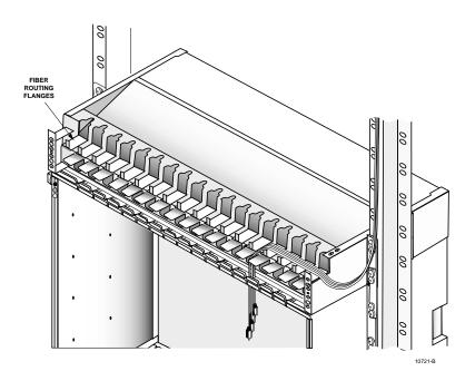
Figure 701-4. Fiber Routing
